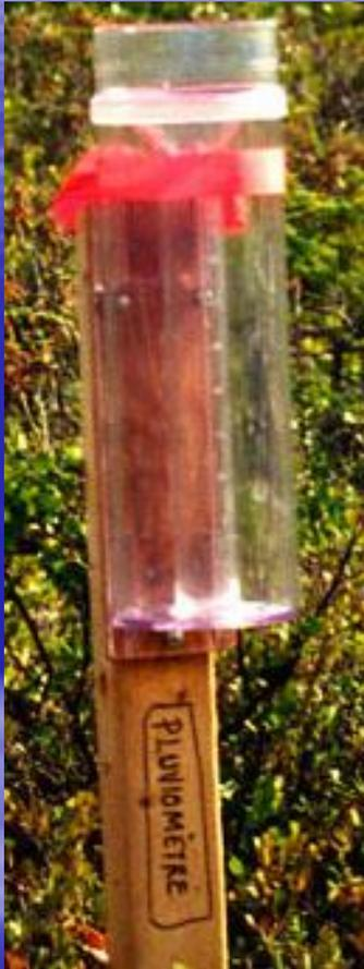
Le pluviomètre est composé d'un entonnoir et d'un tube gradué.
