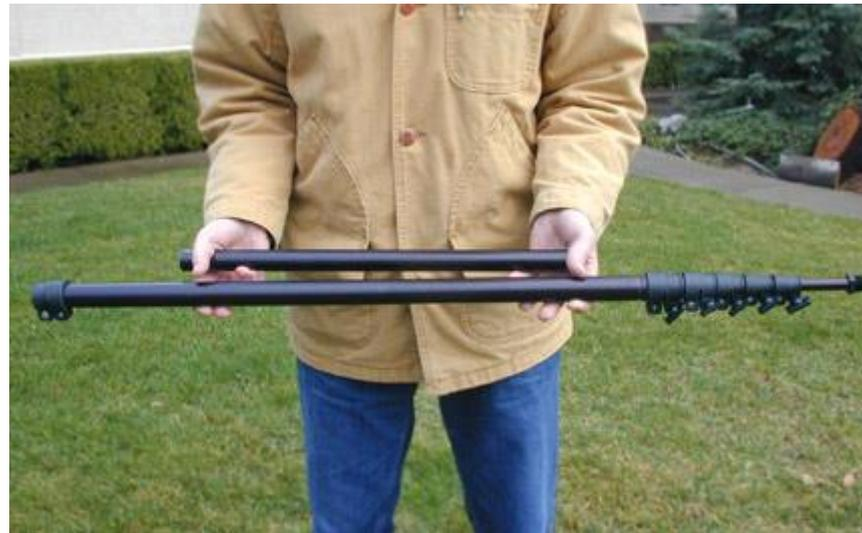
Mât de 16 pieds avec un renfort lorsqu'installé dans le trépied.
