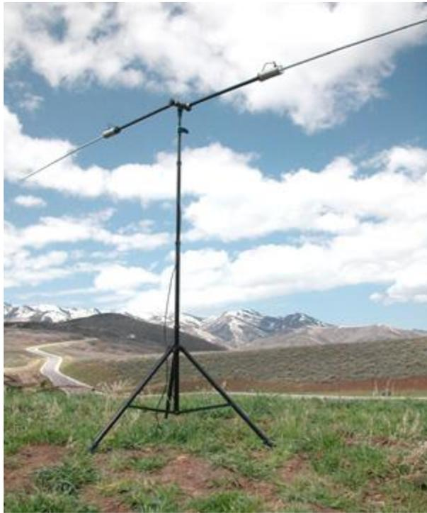
Cette antenne est composée d'un centre fait en forme de « T » qui a la particularité de se visser sur un mât télescopique semblable au (un mât de peintre)» ces mâts télescopiques se vendent dans toutes les bonnes quincailleries.
