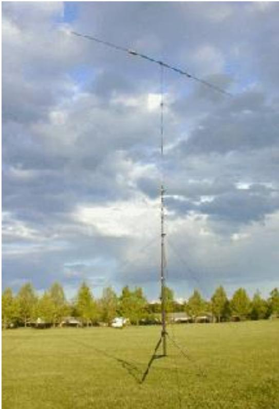
l'antenne est installée et prête à être utilisée, sur la photo elle est à 16 pieds du sol et on peut voir de petits haubans qui ont été installés en cas de vents.
