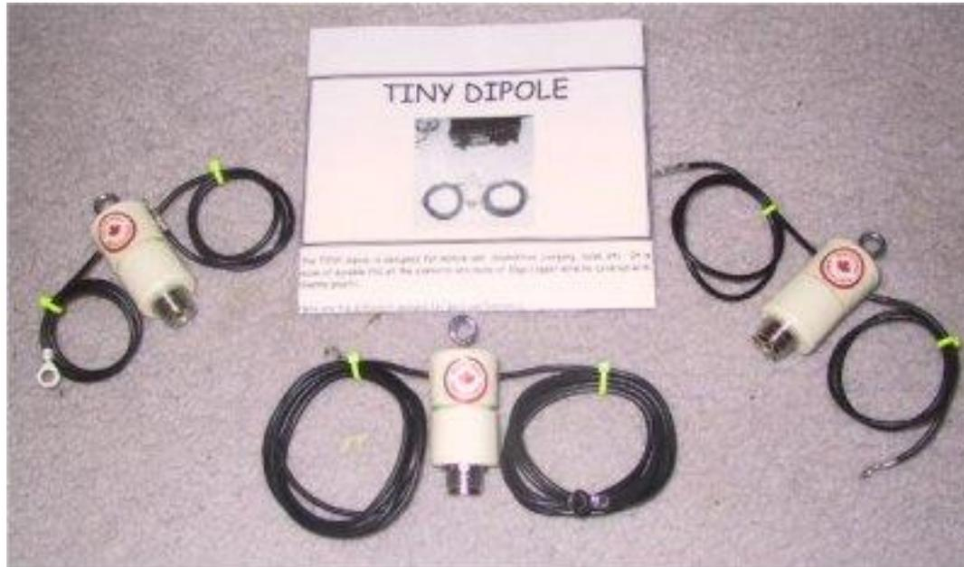
Variété de dipôle solide, mono-bande, avec centre d'antenne fait de PVC prêt à recevoir un câble coaxial.
