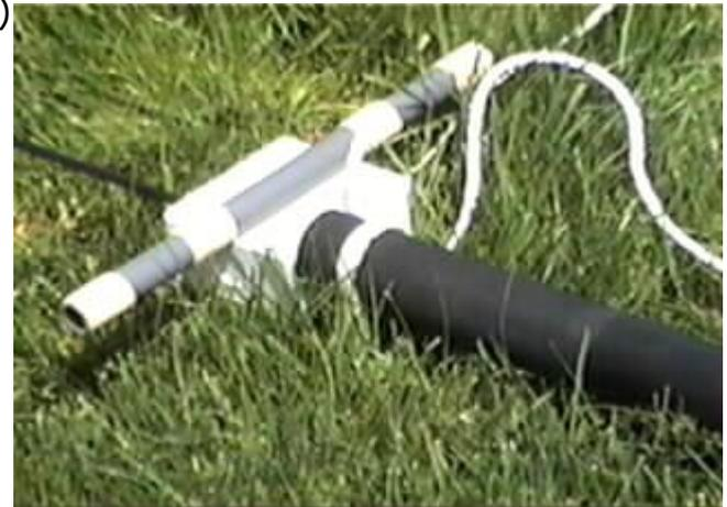
Ci-haut, la boite contenant le balun et le connecteur SO-239 ainsi que le support pour les 2 autres baguettes télescopiques de fibre de verre.
