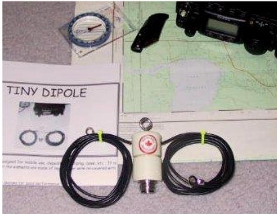
Variété de dipôle solide, mono-bande, avec le centre d'antenne fait de PVC prêt à recevoir un câble coaxial.
