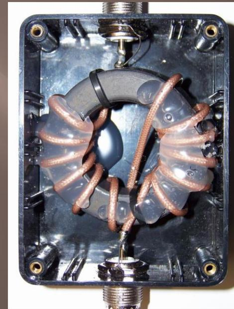
Ajouter de stub d'un  $\frac{1}{4} \lambda$  (coax  $50\Omega$ ) à chaque antenne avec un « T » directement au coupleur:
